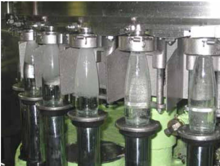
Rドロップスにサイダーが充填される。(フィラー)
