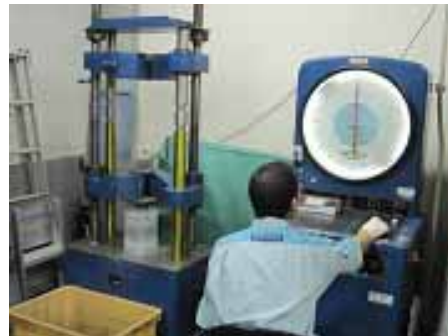
【写真4：垂直荷重強度試験装置】
