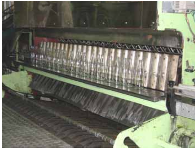
洗びん排出口
