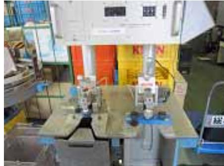
【写真3：耐内圧強度試験装置】
