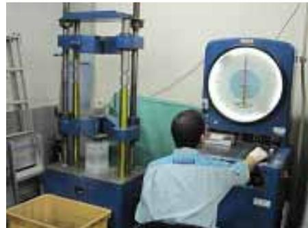
【写真4：垂直荷重強度試験装置】
